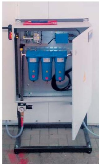
Die Anlage zur Ionisierung und Erwärmung der Zerstäuberluft lässt sich schnell und einfach montieren. **Quelle: ensutec Products**
