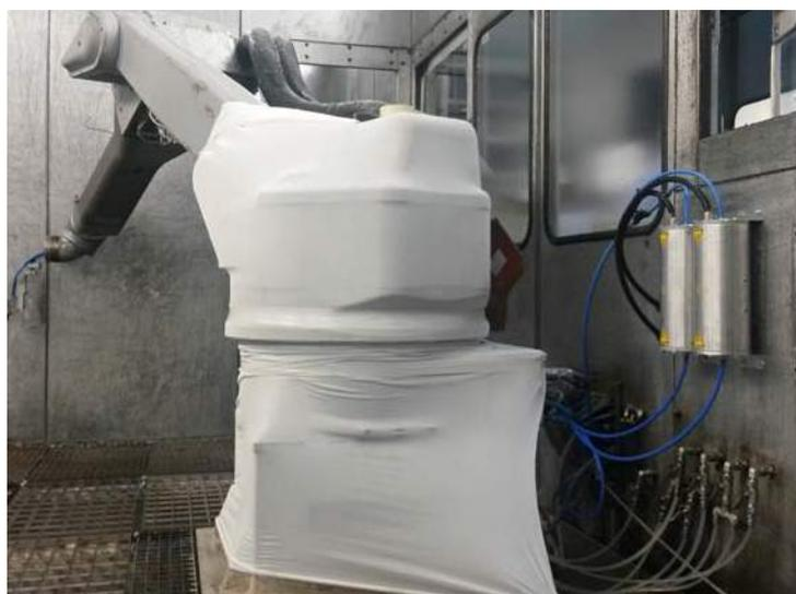
Druckluftaufbereitung mit ATEX-Zulassung in explosionsgefährdeten Bereichen.
