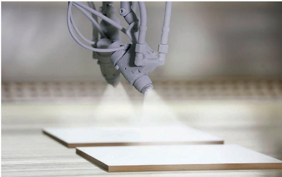
Die Ionisierung und Erwärmung der Zerstäuberdruckluft durch die „airmatic“-Zerstäubungsoptimierung verbessert die Oberflächenqualität und senkt den Lackverbrauch.
