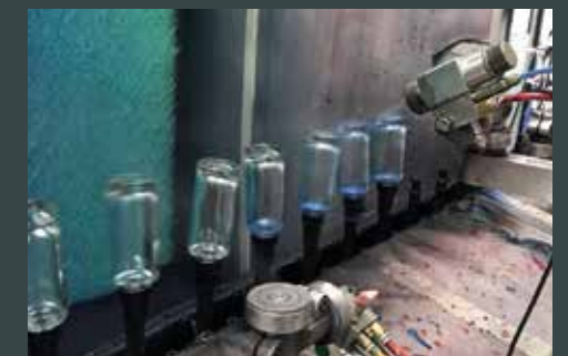
Installation à broches rotatives
