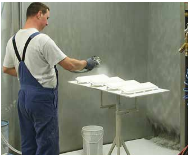
Die airmatic ermöglicht eine Zerstäubung bei niedrigerem Druck.
