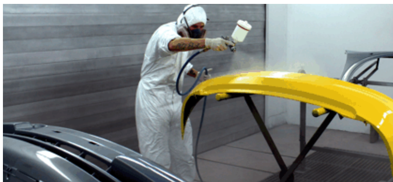
Lackierung von Karosserieteilen
