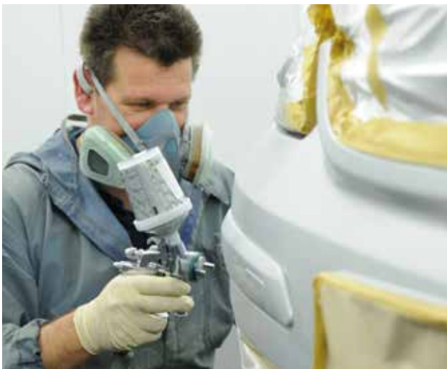
Der Lacknebel wird durch die Ionisierung deutlich reduziert.
