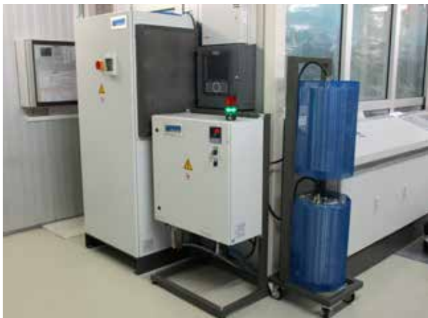
airmatic-Zerstäubungsoptimierung und airmatic-Funktionserdung
