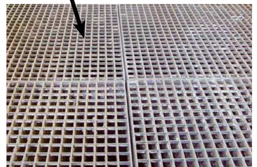
Nach der einfachen manuellen Reinigung der Roste durch Abkehren oder Bürsten ohne Stillstandszeiten ist die Kabine wieder funktionsbereit.
