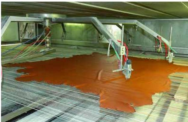
Lackierung mit einem Kreisläufer
