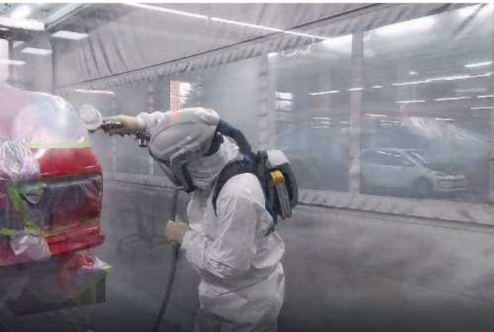
Die Lackzerstäubung ist ein komplexer Prozess. Eine wichtige Rolle kommt dabei der optimalen Aufbereitung der Pistolenluft zu. (Foto: M. Rehm)
