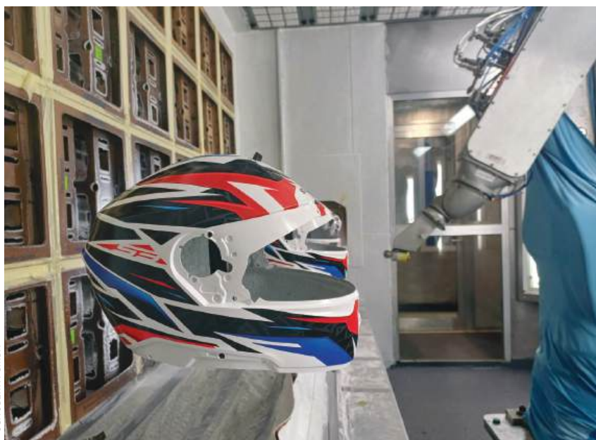
Serienlackierung der S3-Helmschalen mit Dekor-Applikation des glänzenden Klarlacks.
